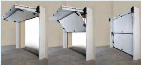
Durch zwei Torabschnitte, die beim Zusammenklappen übereinandergleiten, kann auf die üblichen Deckenschienen verzichtet werden. Dank dieser neuen Überlappungstechnik kann der innere Platzbedarf um bis zu 50 Prozent reduziert werden. Diese Tore eignen sich vor allem auch bei geringeren Raumhöhen, da an der Decke bis zu 20 cm eingespart werden kann. Der Torantrieb ist übrigens direkt in den Rahmen integriert.
