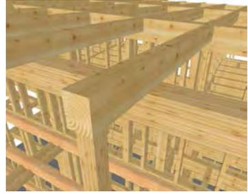
**Die Holzrahmenbauweise ist durch äußerste Einfachheit gekennzeichnet, sodass dieses System mit der Industrialisierung schon bald auch zum bevorzugten Bauverfahren der Fertighausindustrie wurde. Die Holzrahmenbauweise wird weltweit nach denselben konstruktiven Regeln angewandt. Erfahrungswerte aus mehreren hundert Jahren machen dieses Bausystem zum Klassiker aller Holzbauweisen.**
