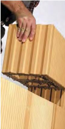
belasteter Pfeiler oder Aussteifungswände bestens geeignet. Plan-Füllziegel werden in der Regel mit mörtelfreien Stoßfugen knirsch versetzt. Die Lagerfuge wird mit Dünnbettmörtel ausgeführt. Dazu kann der Mörtel wahlweise mit Auftragsgerät (z.B. Mörtelwalze) oder im Tauchverfahren verarbeitet werden.
