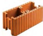
Schalungsziegel für Wohnungs-/ Haustrennwände zum Verfüllen mit fließfähigem Beton C12/15, Körnung 0-16 mm mit oder ohne Horizontal- / Vertikalbewehrung
