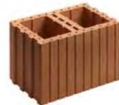
Schallschutz-Füllziegel für Wohnungs-/ Haustrennwände zum Verfüllen mit fließfähigem Beton C12/15, Körnung 0-16 mm mit oder ohne Vertikalbewehrung
