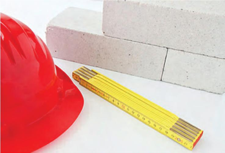
Zement und Wasser entsteht in der Herstellung eine feine Porenstruktur die charakteristisch für den Porenbeton ist. Durch den hohen Luftanteil haben Mauersteine aus Porenbeton eine geringe Rohdichte; besitzen jedoch trotzdem eine hohe Festigkeit. Sie erzielen Wärmeleitfähigkeiten von bis zu 0,09 Watt pro Meter und Kelvin was sich bestens auf die Wärmedämmeigenschaften des Baustoffes auswirkt. Im Schall-
