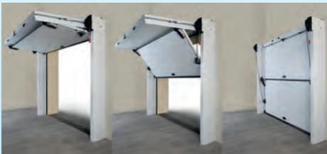
Durch zwei Torabschnitten, welche beim Zusammenklappen übereinandergleiten, kann auf die üblichen Deckenschiene verzichtet werden. Dank dieser neuen Überlappungstechnik kann der innere Platzbedarf um bis zu 50 Prozent reduziert werden. Diese Tore eignen sich vor allem auch bei geringeren Raumhöhen, da an der Decke bis zu 20 cm eingespart werden können. Der Torantrieb ist übrigens direkt im Rahmen integriert.
