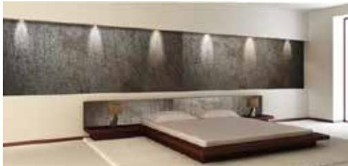
**Die ultradünnen Natursteinplatten sind ideal beim Renovieren und Sanieren. Mit einem Spezialkleber kann der Belag auf fast allen Untergründen angebracht werden. Mit insgesamt nur fünf Millimeter Aufbauhöhe sind keine lästigen Abbrucharbeiten oder Quotenänderungen erforderlich. Die großen Formate ermöglichen ein fast fugenloses Bild.**
