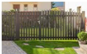
robust. Alu-Zäune bilden von sich aus bei der Fertigung eine dichte Oxidschicht, die als natürlicher Rostschutz dient und die Zäune sehr witterfest macht. Dadurch ist ein Aluminiumzaun ganz ohne Lack sehr lange haltbar – und behält sein Aussehen über viele Jahre. Das ist gerade bei großflächigen Toren, die ständiger Benutzung ausgesetzt sind, besonders wichtig.
